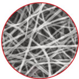
В отличие от традиционных фильтров, фильтры изготовлены из нетканого полиэстера фильтрация происходит не в фильтре, а на поверхности. Следовательно:
