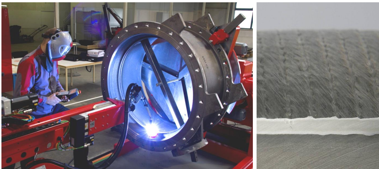
Рис. 2. Наплавка уплотнительного выступа в корпусе крана методом CMT. 97,5% Ar + 2,5 % CO 2 . Коррозионностойкий слой. Диаметр присадочной проволоки 1,2 мм. Скорость наплавки 60 см/мин.
