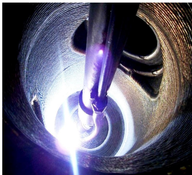
Рис. 1 Клапан запорной арматуры, наплавленный THW.
