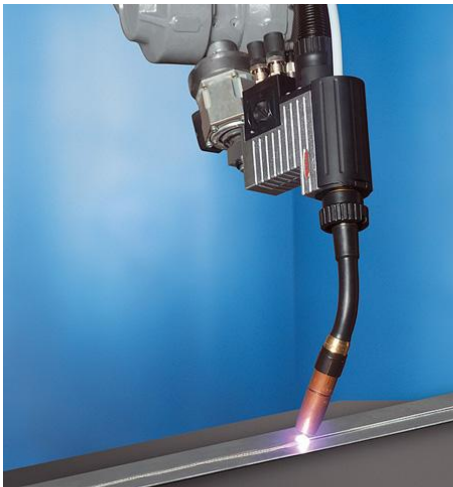
Рисунок 2: Сварка и пайка ультратонких листов толщиной от 0,3 мм, соединение листов из стали и алюминия, сварка оцинкованных листов – это лишь некоторые из многочисленных инновационных способов применения новой технологии от компании Fronius.
