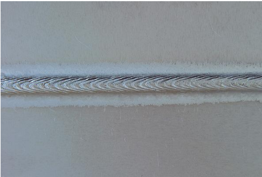
Рисунок 5: Тавровый шов на листе AlMg3 толщиной 1,0 мм, выполненный с использованием технологии СМТ при скорости сварки 2,0 м/мин.
