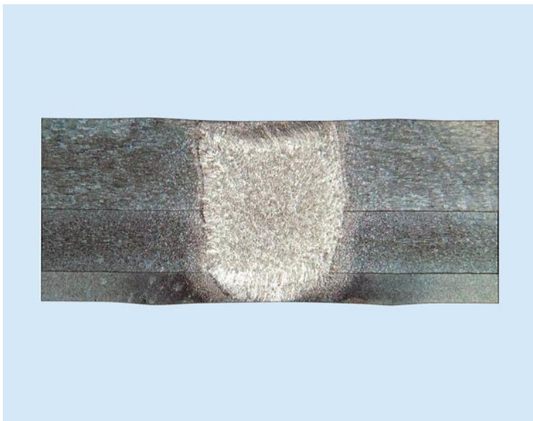
Рис. 3. Соединение трёх листовых элементов: инновационный процесс контактной точечной сварки DeltaSpot выполняет любые типы сварных соединений. Здесь представлено: три алюминиевых листа (0,3 мм, 2,0 мм и 1,0 мм – сплав АМг3) сварены с помощью контактной ленты с покрытием на следующем режиме: ток 17 кА, 700 мс; сила сжатия 4 кН.
