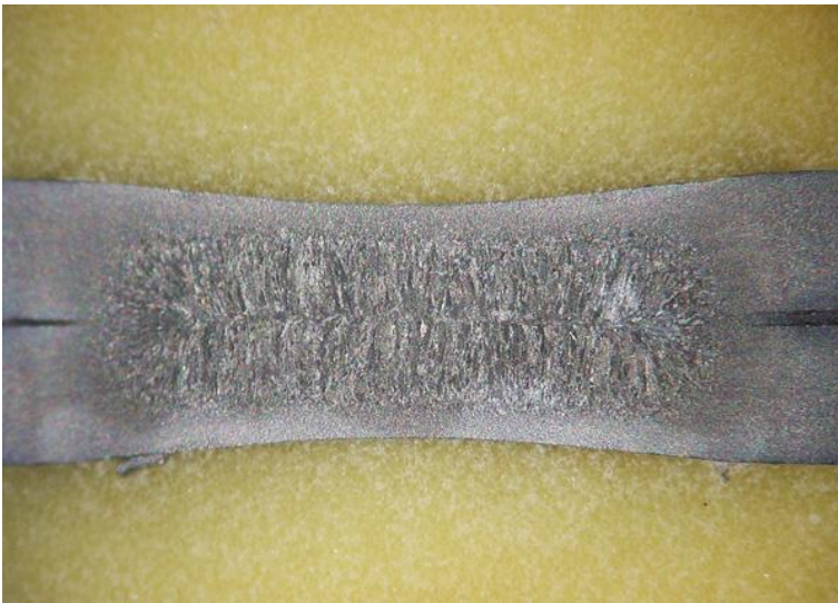
Рис. 4. Сочетания материалов: электролитически гальванизованный лист из стали TRIP 800, 2 мм (снизу); горячеоцинкованный лист из стали DP 600, 2.0 мм (сверху). Сила сжатия 5 кН, ток сварки 9 кА.
