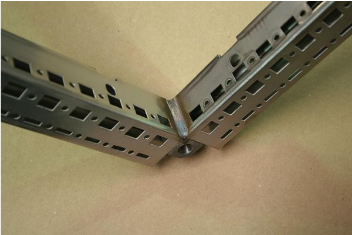
Рис. 5: Технология СМТ компании Fronius гарантирует получение ровных швов и отсутствие брызг при сварке от начала и до конца производственного процесса. Эти конструкции из хромоникелевой стали являются типовыми изделиями завода HABS в г. Могендорф.
