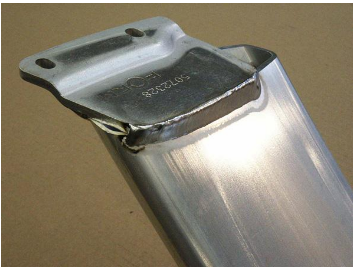
Рис. 2: Надежность и привлекательный внешний вид сварных швов являются ключевыми факторами при сварке алюминиевых трубчатых каркасов для спортивных автомобилей на предприятии ELB-Form.
