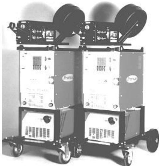
Рис. 4. Скоординированные инверторные источники питания для MIG сварки алюминиевых материалов с использованием двух проволочных электродов.
