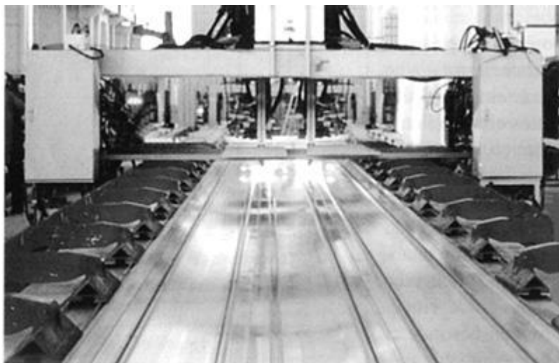
Рис. 7. Одновременное использование двух горелок при производстве железнодорожного подвижного состава
