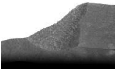
Рис. 6. Сварной шов, выполненный при скорости 130 см/мин., на внутренней поверхности обода диска легкового автомобиля
