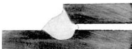
Рис. 8. Поперечный разрез таврового шва внахлестку с 2 мм воздушным зазором, выполненного на скорости 100 см/мин. в горизонтальном положении
