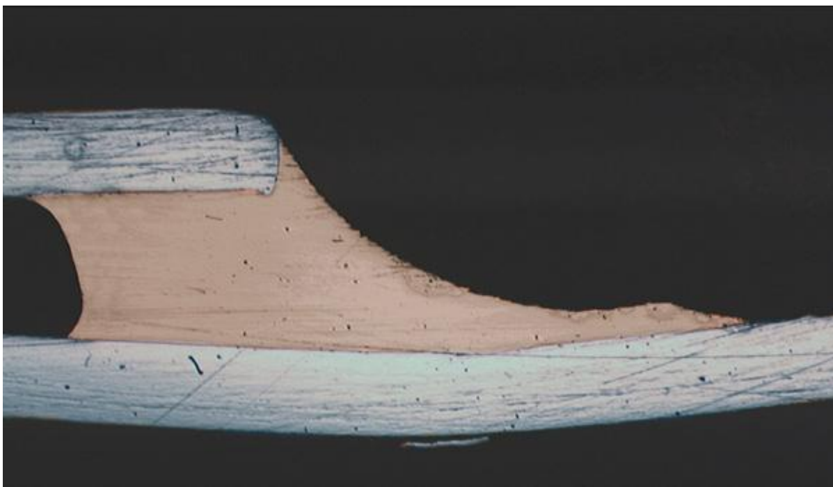
Рис. 1: Оптимальное перекрытие зазора
