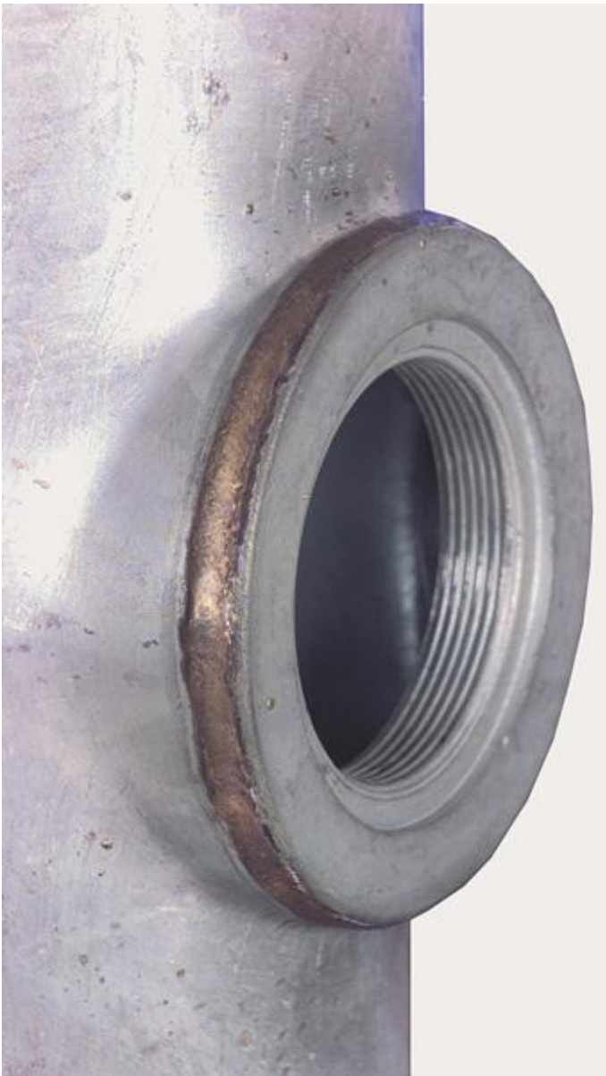
Рис. 2: Технология пайки с низким уровнем разбрызгивания
