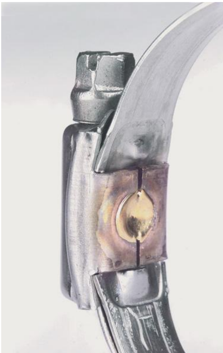
Рис.3: Хомут шланга, изготовленный из хромоникелевой стали
