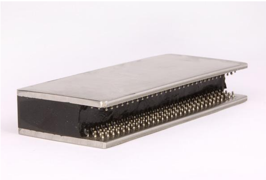
Рис. 4 (а,б): Разъемные штифтовые соединения типа «липучка».
