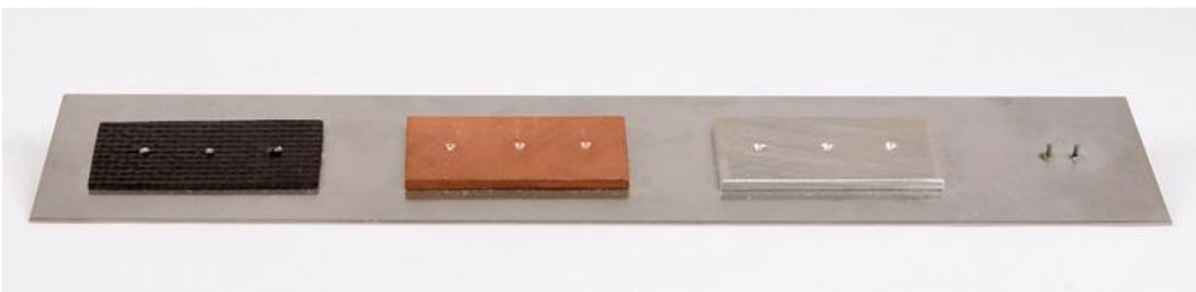
Рис. 3: Нежесткое «штифтовое» соединение заклепочного типа с покрытием из других материалов.
