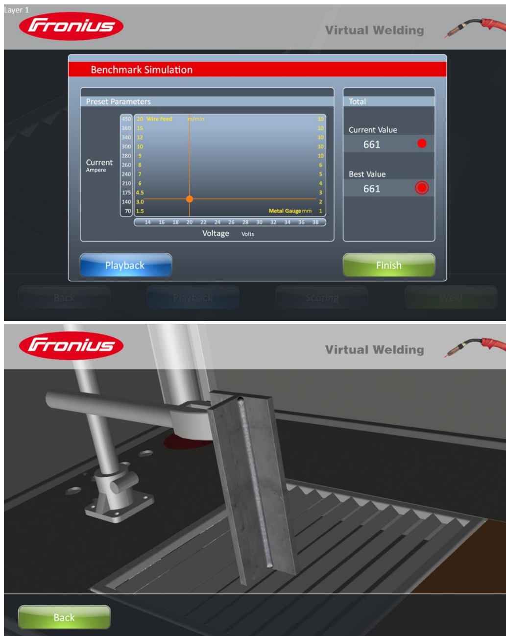
Рисунок 3: Магнитная система слежения считывает физические движения руки, выполняемые пользователем с моделью горелки, и преобразует их в виртуальные. Индивидуальный учебный прогресс может быть сохранен, а затем использован для демонстрации с целью повышения собственной уверенности.
