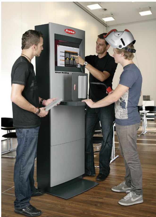
Рисунок 1: Виртуальная сварка позволяет учащемуся получить необходимые навыки в безопасной и расслабленной обстановке, прежде чем ему дадут горелку, и он впервые окажется один на один с дугой, имеющей температуру 2 000 °С. Оптические датчики расположены в каске, а кинетические (магнитные) датчики находятся под учебной заготовкой.
