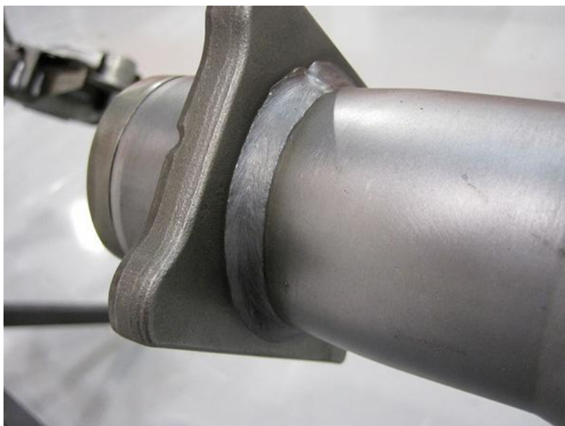
Рис. 5: Тавровый шов между стальной трубой и фланцем, a = 5 мм, скорость подачи проволоки: 12 м/мин., скорость сварки: 90 см/мин., присадочный металл ER 70 с диаметром проволоки 1,4 мм.
