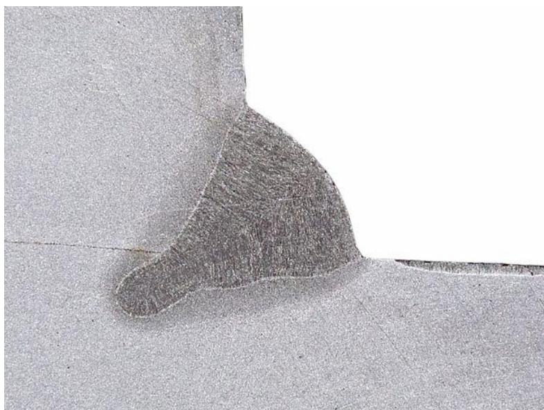
Рис. 4: Сечения обоих швов с очевидностью отражают различия. Первым показан шов, полученный импульсной сваркой; вторым – тавровый шов, выполненный с применением PCS (дуга со струйным переносом металла с импульсным управлением).
