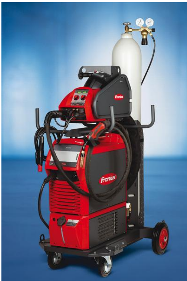
Рис. 1: Сварочная система TransSteel 3500 G Standard Yard с газовым охлаждением адаптирована для нужд пользователей в сфере судостроения и производства морских установок. Прочие характеристики: устройство подачи проволоки VR 5000 Yard 4R/W, снабженное средством Fronius System Connector (FSC), блок соединительных шлангов, набор для установки средства перемещения с помощью крана, крепление поворотного фиксатора Pickup 5000 Yard, кабель заземления и регулятор давления.
