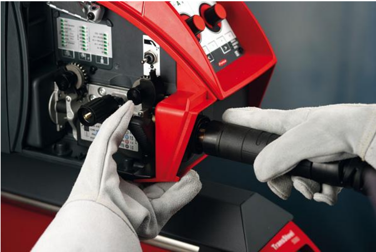
Рис. 5: Fronius System Connector (FSC) обеспечивает подсоединение центральной горелки для всех типов рабочей среды, а точная подача тока обеспечивает наивысший уровень стабильности процесса. Это стандартное оборудование для версии Yard серии TransSteel.
