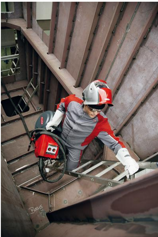
Рис. 8: Масса практичного устройства подачи проволоки вместе с дисплеем и горелкой составляет 16,5 кг. При этом оно может быть легко отсоединено от источника питания и перемещено на труднодоступные для сварки участки.
