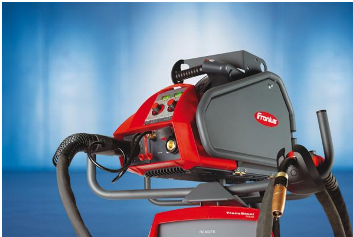
Рис. 2: Устройство подачи проволоки TransSteel Yard может быть отдельным, перемещающимся по направляющим, а ручка и собственное крановое приспособление делают его весьма мобильным.
