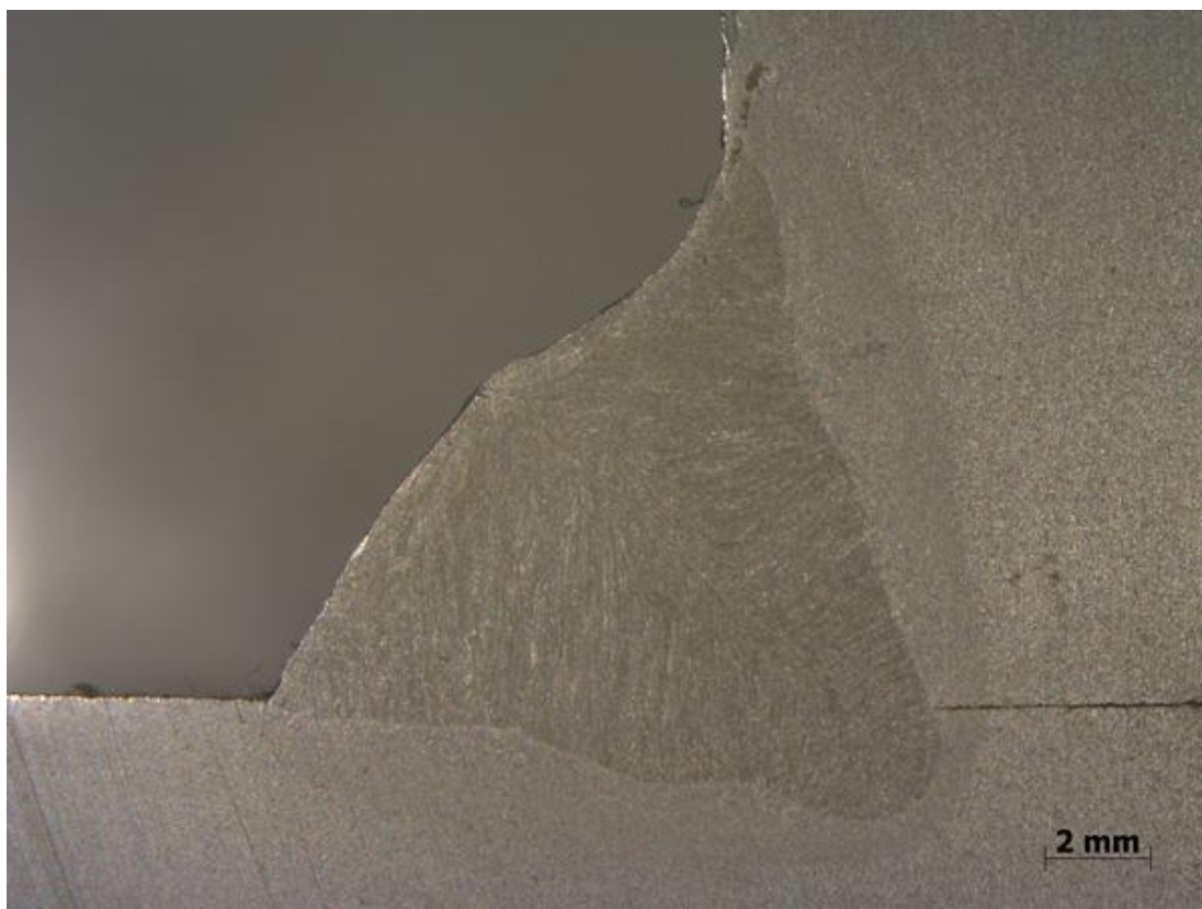
Рисунок 4: Технология СМТ Twin позволяет сварщикам добиваться показательных результатов даже при сварке тавровых швов в положении РВ.
