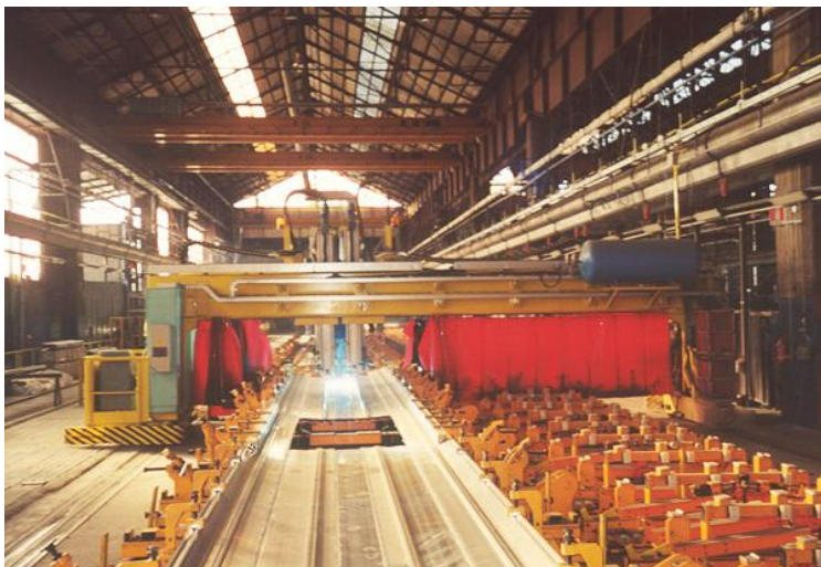
Рисунок 9: Тандемная сварка при производстве железнодорожных вагонов. Достигнутая скорость сварки: 250 см / мин.
