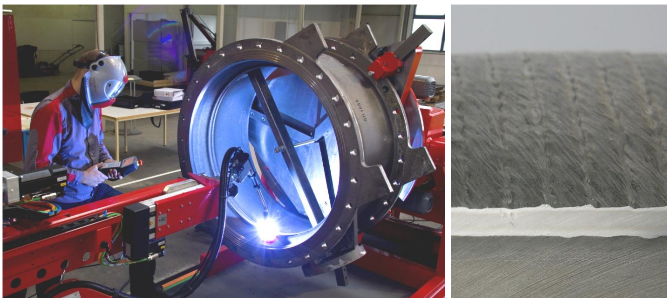
Рис. 2. Наплавка уплотнительного выступа в корпусе крана методом СМТ. 97,5% Ar + 2,5 % CO 2 Коррозионностойкий слой. Диаметр присадочной проволоки 1, 2 мм. Скорость наплавки 60 см/мин.
