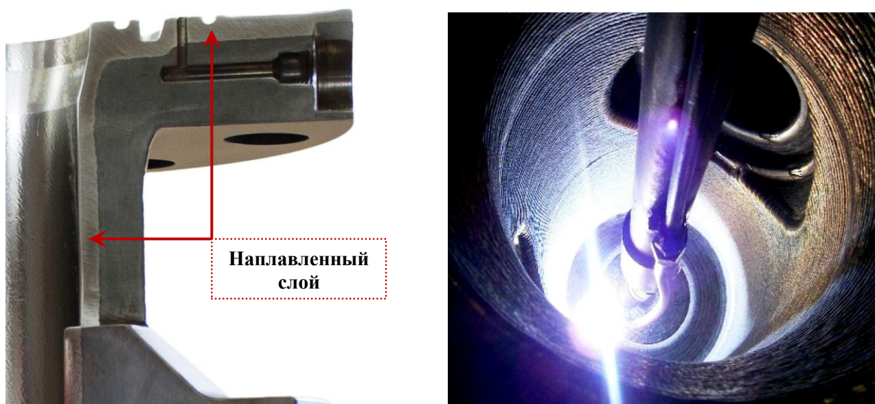
Рис. 1 Клапан запорной арматуры, наплавленный THW. Слой из жаростойкого никелевого сплава Inconel 625. Диаметр присадочной проволоки 1, 2 мм. Скорость наплавки - 32 см/мин.
